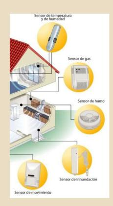
Los sensores pueden estar conectados a una computadora para obtener ventajas como el acceso a una base de datos, la toma de valores desde el sensor en tiempo real en algunos casos, etc.
