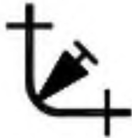
Válvula en montante:
