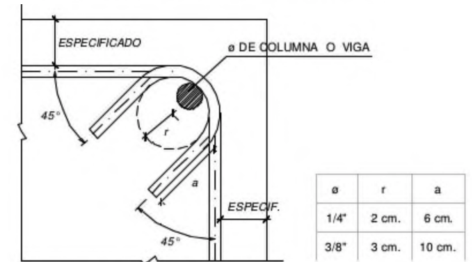
DETALLE DE DOBLADO DE ESTRIBOS EN COLUMNAS Y VIGA
