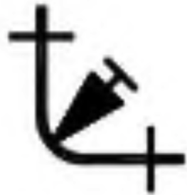
Válvula en montante:
