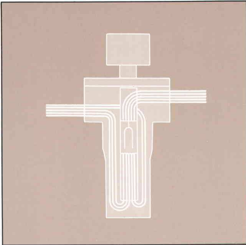
Método de medición de densidad por horquilla oscilante.
