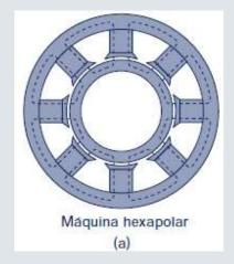
Como regla general, los campos magnéticos de las máquinas eléctricas son producidos por electroimanes, es así que, se puede regular dichos campos, si regulamos las bobinas que constituyen el electroimán, estas bobinas se denominan *bobinas* excitadoras y la corriente que circula por ellas corriente de excitación.
