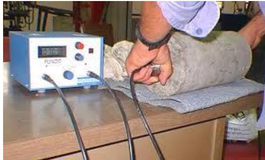
**Arrancamiento:** Ensayo semidestructivo por el cual se obtiene la resistencia a tracción y la consistencia del hormigón, indirectamente, su resistencia a compresión.
