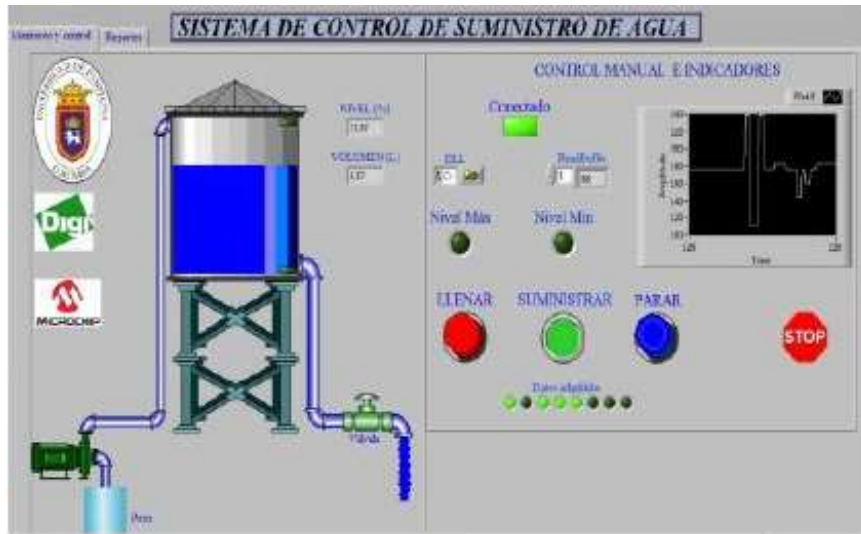
Figura 4: Sistema de control de suministro de agua.
